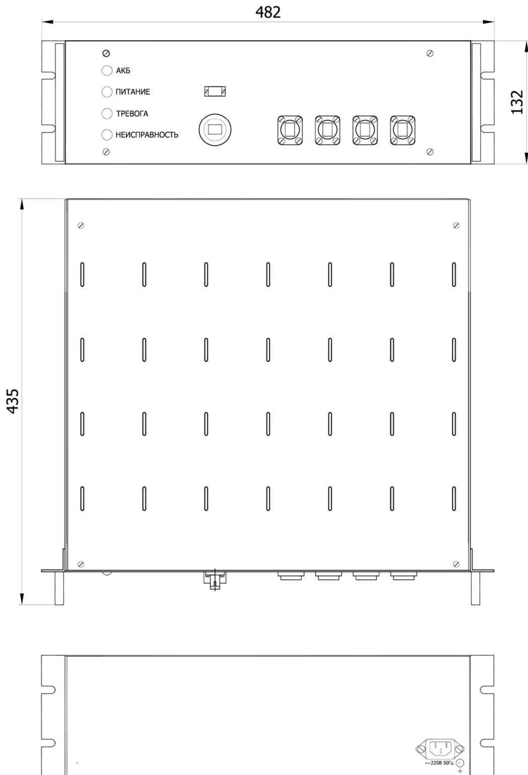
Рисунок 1.2 - Габаритный чертёж блока обработки сигналов ТОПОЛЬ ВО/19-Б-1
